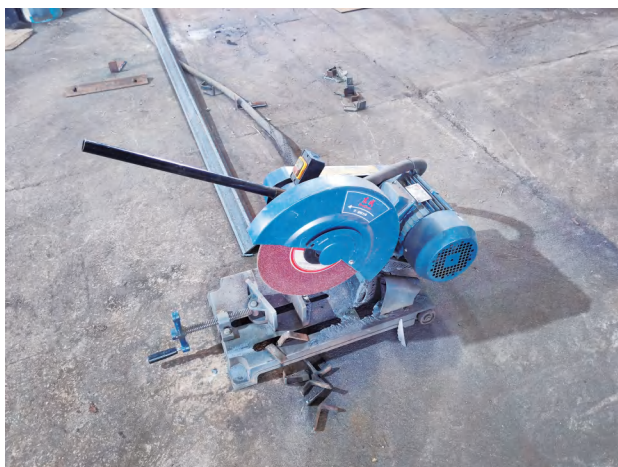
石家庄某构件加工厂切割机无防护挡板，企业发现后立即进行了整改。 田园 摄
